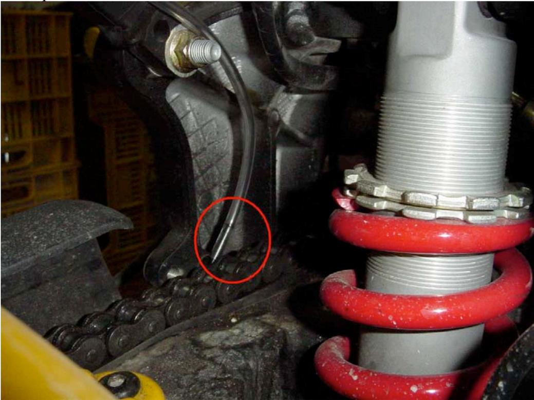
Llegados a este punto, procedemos a colocar el deposito de aceite, para ello colocamos una plantilla en ángulo con un tornillo soldado que viene en el kit, lo colocamos en el agujero del centro (lleva tres) como se ve en la siguiente imagen, y tener cuidado que no impida el giro de la cerradura del asiento/tapa trasero, para ello presentar el colín para comprobar esta circunstancia.
