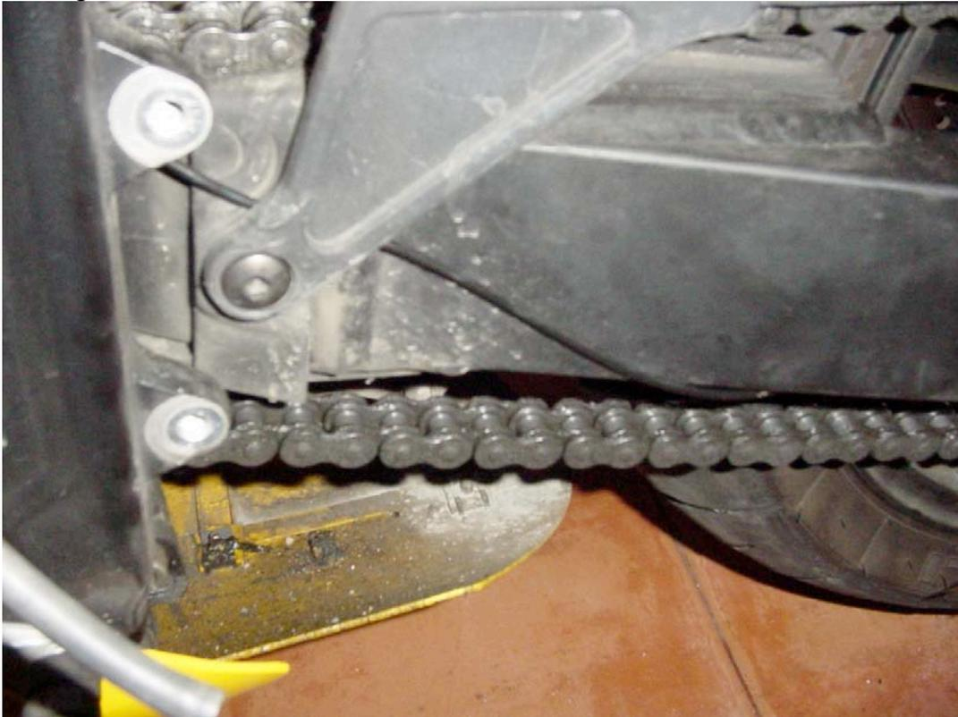
Ahora se coloca una guía para el tubo transparente, por la parte trasera del travesaño que va desde el chasis hasta el colín, esta guía que viene en el “kit universal”, se corta a la medida, colocamos el tubo transparente, y sujetamos con cinta aislante, para después colocar unas bridas de plástico.
