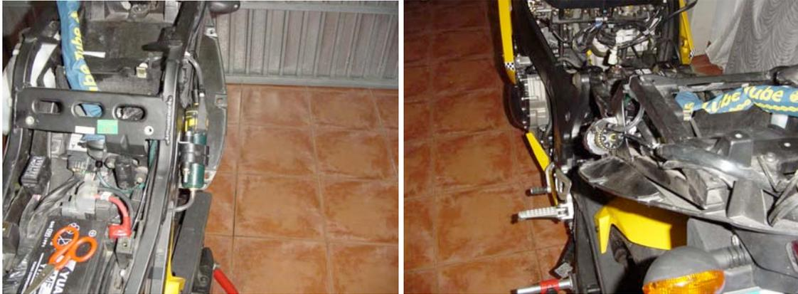
Ya esta casi todo instalado, solo queda lo mas importante para que funcione tu scottoiler, conectar al tubito negro desde el deposito de aceite a la toma de vacío del motor, llevar el tubo lo mas protegido posible y sin que roce con ninguna parte móvil de la moto para evitar su rotura.
