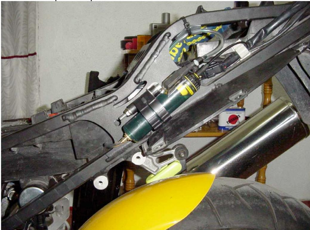
Ya tenemos colocado el deposito de aceite, y si no hemos elegido el “lube tube” adicional, llenamos el deposito y colocamos el tapón-respiradero que a su vez nos servirá de llenado cuando tengamos que repostar de aceite.
